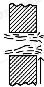
气蚀发生在 套筒壁上
